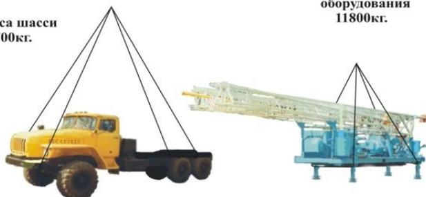
Рисунок 2 – Буровая установка УРБ – 3А3
